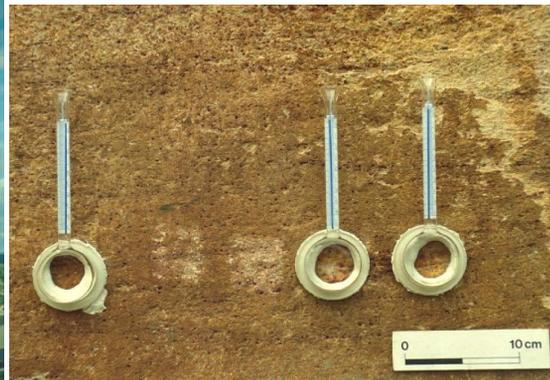
그림 20. 카르스텐 관에 의한 물흡수 측정.
